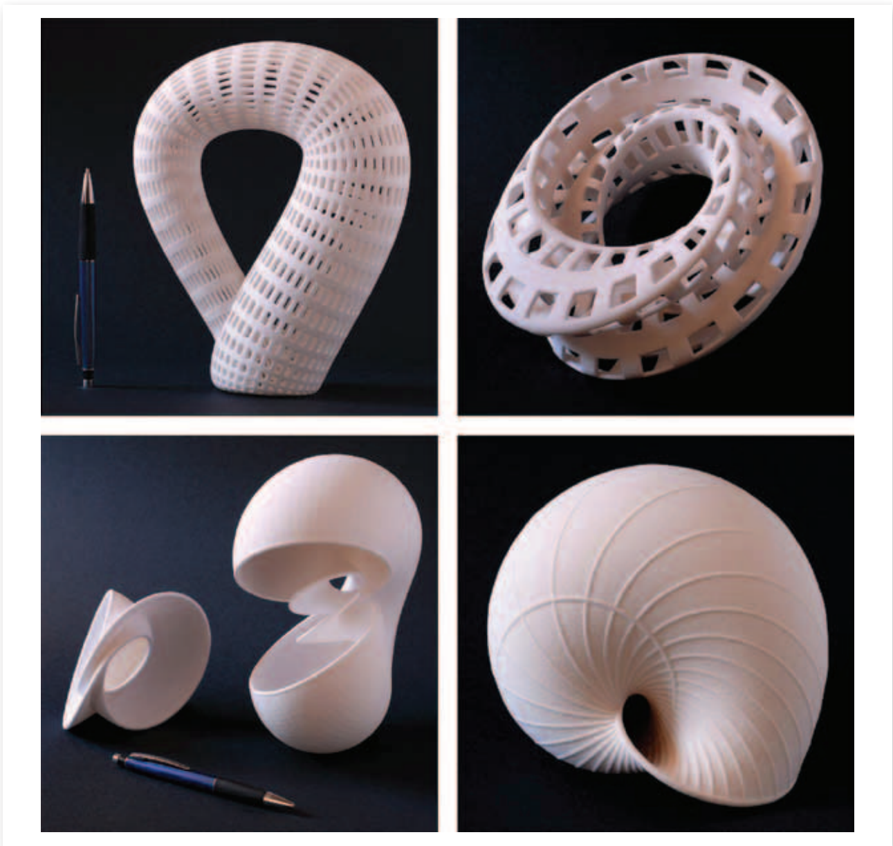
圖 12 四張不同版本克萊恩瓶以 3D 列印系統 Z-Printer Z310 Plus 列印的模型照片（材料：石膏）。左上圖：依據參數式（9）與（10）。右上圖：依據參數式（1）。左下圖：依據參數式（2）再切成兩部分的勞森瓶。右下圖：勞森瓶另一種切法的一半，這兩半都是以圓為邊界的莫比烏斯帶，其中強調了一些在曲面上的圓弧。（模型及照片由作者製作。）
