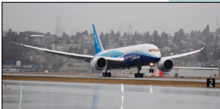
波音787首航結束時的降落畫面。機翼彈性程度由此圖可見一斑。
